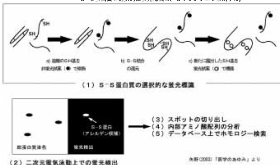
図1 アレルゲン候補蛋白質の検出手順： S-S蛋白質を選択的に蛍光標識し、UVランプ上で検出する。
