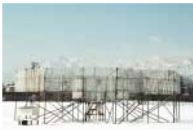
図1 比較の基準に用いた二重柵基準降水量計。細い板を並べた柵で降水量計を二重に囲ってある。柵は八角形をしており、差し渡しは外側が1.2m、内側が4mである。柵上端の高さは外側が4m、内側が3.5m。降水量計の開口部の高さは3.5mである。
