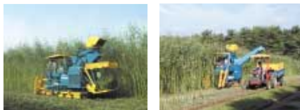
図3 開発したケナフ収穫機 (左: ネットバッグ方式、右: 伴走ワゴン方式)
