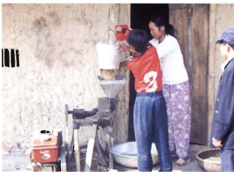
Dien Bien郡の農家での豆乳作り。動力式の磨砕機で、水に浸したダイズから豆乳をしぼる。
