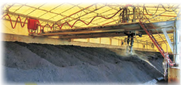
ブロイラー鶏ふんと 焼酎粕(焼酎廃液)の 共堆肥化
