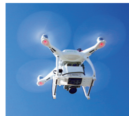
図1 マルチスペクトルカメラSequoiaを搭載したドローンPhantom 4 Pro
