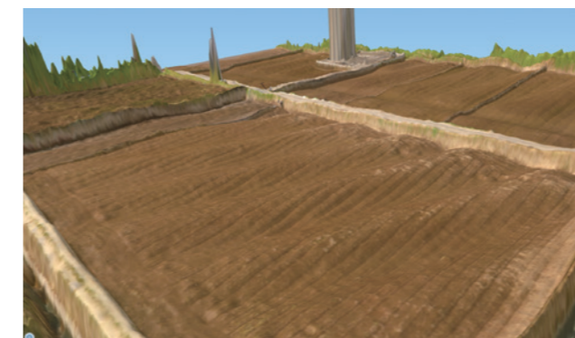
図1 ドローン空撮画像より作成したほ場表面の3次元モデル（高さ方向は数倍に強調）
