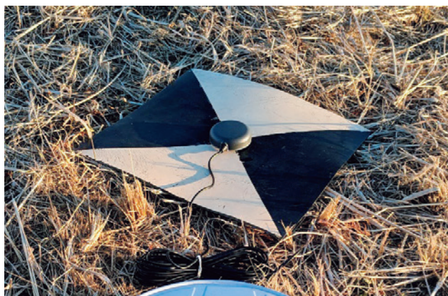
図4 小型GNSS受信機による対空標識の測位
