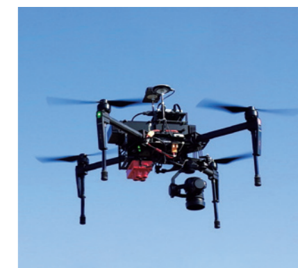
図3 マルチスペクトルカメラRedEdgeを搭載したドローンMatrice 100
