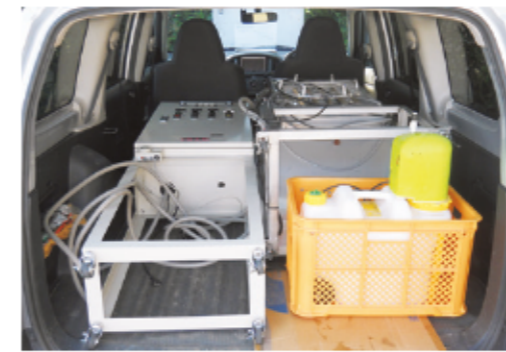
図4 ライトバンに積載した小型ポータブル式蒸熱処理防除装置 後席を倒すと、装置本体と制御盤、加湿ポンプなどを積載できる。
