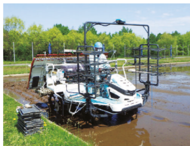
図1 評価試験に用いた自動操舵機能付き田植機
