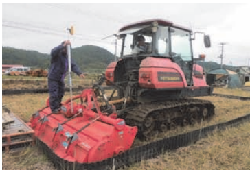
① レーザーレベルセンサー付きトラクターによる土壌解砕
