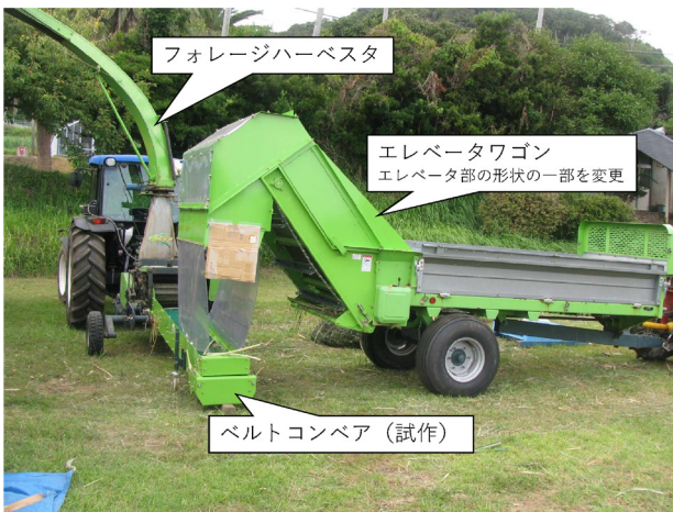
第2図 開発した再切断装置
