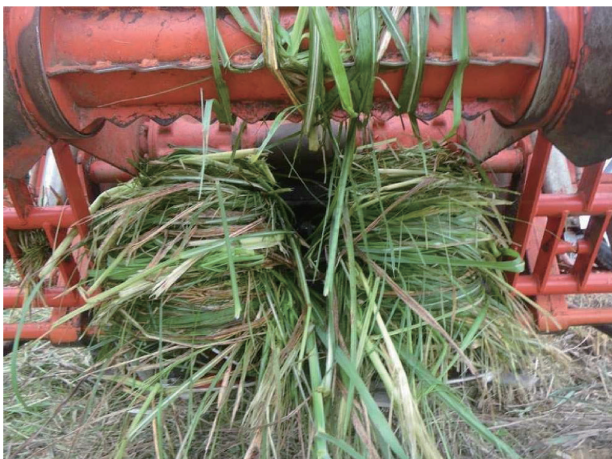
第1図 ベースカッターへの巻き付き状況 左：改良前 右：改良後
