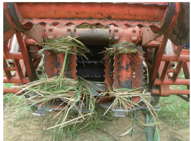
第1図 ベースカッターへの巻き付き状況 左：改良前 右：改良後
