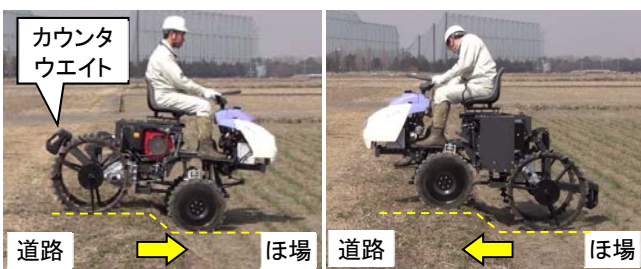
図 3 走行部 1 号機による段差昇降性能調査 （左：ほ場進入（後傾）、右：ほ場退出（前傾））
