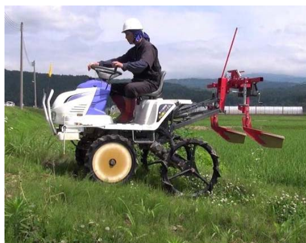
図8 開発機の後輪昇降機構を利用した傾斜地走行の様子（溝切機装着時）
