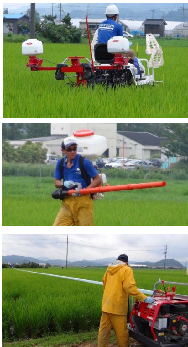
図 15 現地試験における肥料・薬剤散布の様子 上：開発機(同時散布)， 中：慣行機(肥料散布)， 下：慣行機(薬剤散布)，ともに現地④
