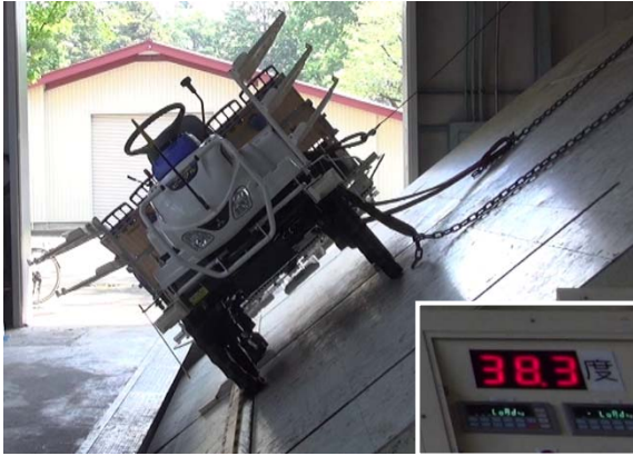
図9 開発機の静的横転倒角計測の様子 (田植機装着時)
