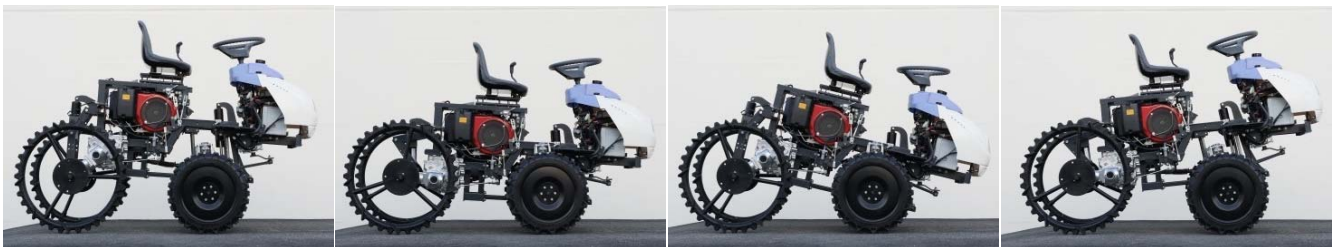
図2 走行部 1号機の車輪昇降機構による姿勢移行 (左から「作業」、「走行」、「前傾(退出時)」、「後傾(進入時)」)
