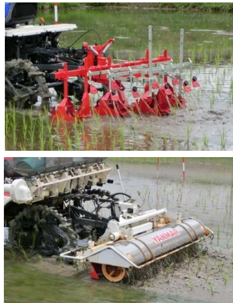
図12 現地試験における除草の様子（上：開発機，下：対照機，ともに現地③）
