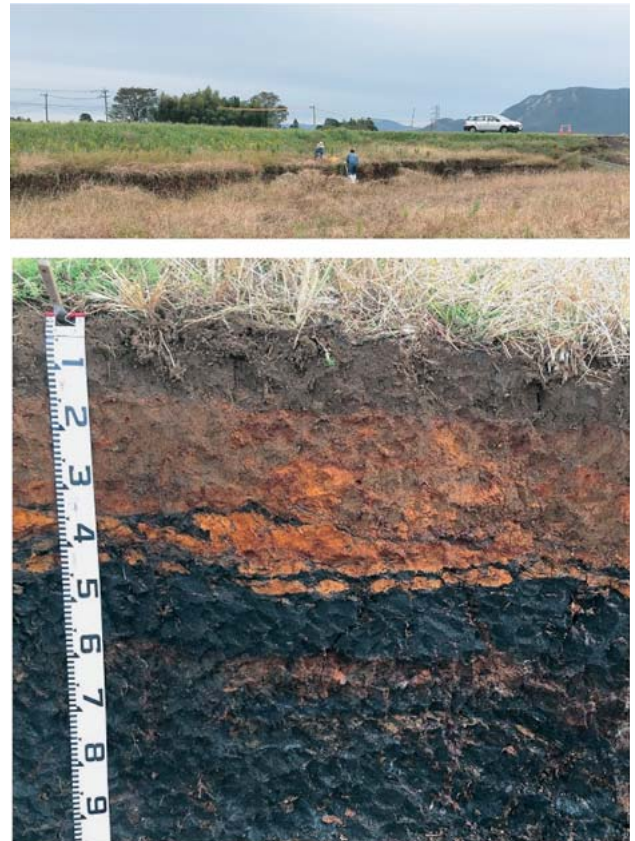
写真2 土壌断面調査地点周辺の景観 (上) と段差を伴った亀裂における土壌断面 (下)
