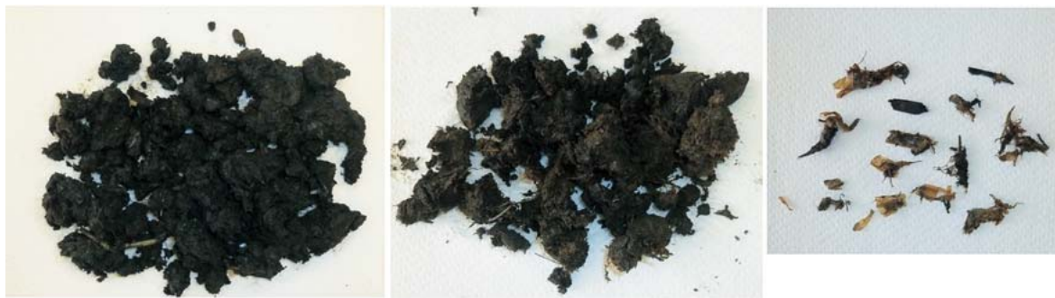
写真1 調査圃場から採取した酸性硫酸塩土壌と泥炭物質（左：工区1—B圃場の採取地点2の80～100 cm深の土層，中央：工区2—C圃場の採取地点5の80～100 cm深の土層，右：工区1—B圃場の採取地点2の80～100 cm深の土層に含まれていた泥炭物質）
