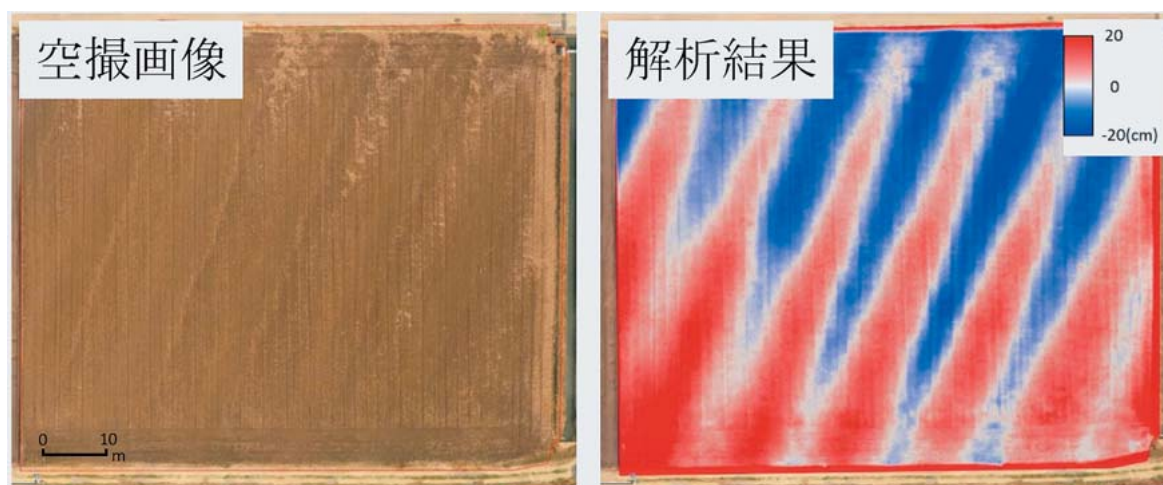
第2図 農地に生じた不陸量の解析結果 (野見山ら, 2018)
