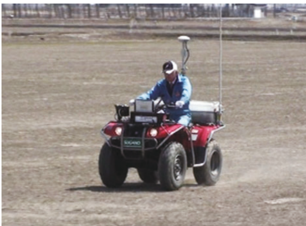
写真Ⅱ-1 RTK-GNSS受信機搭載車両
