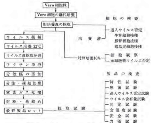
図3. 牛痘組織培養ワクチンの製造と検査のあらまし
