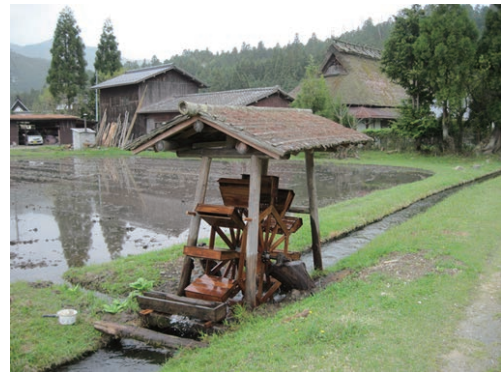
Fig. 79 揚水水車 (B形式：京都市京都市) IWW (B-type in Kyoto, Kyoto pref.)
