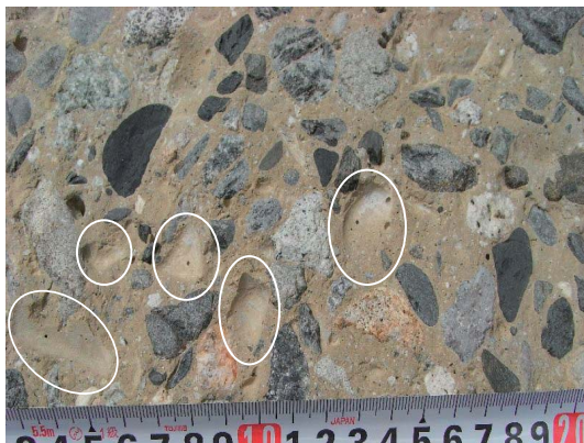
Fig. 26 摩耗表面の拡大 (白丸で囲った部分は、粗骨材の脱離した痕) Macrograph of abraded surface. White circles indicate the desorption pits of coarse aggregate.
