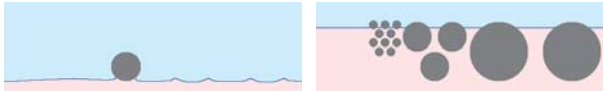
(a) Ca 溶脱有 (b) Ca 溶脱無し Fig. 100 「等方」作用における溶脱有無別の40年後の摩耗状況 Eroded states after 40 years by the isotropic action with and without Ca leaching
