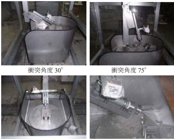
衝突角度 30° 衝突角度 75° 試験体 1 個を中央部に設置 水噴流の吐出 Fig. 77 新型試験機の状況 Conditions of the new water jet erosion tester
