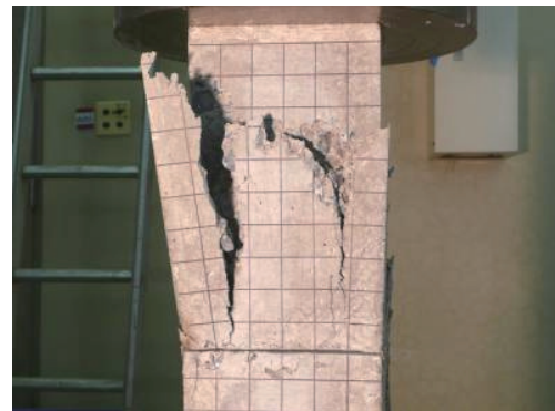
Fig.2-50 供試体 C-2 の破壊状況 Broken specimen (C-2)
