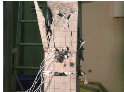
Fig.2-49 供試体 C-1 の破壊状況 Broken specimen (C-1)
