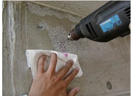
Fig.3-4 ドリル法による中酸化深さの測定 Measurement of carbonation depth using drill
