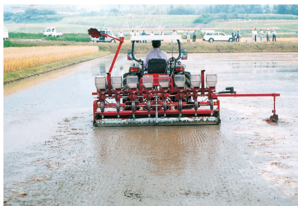
写真1 打込み式代かき同時土中点播機 （代かき整地と播種を同時に行っている）
