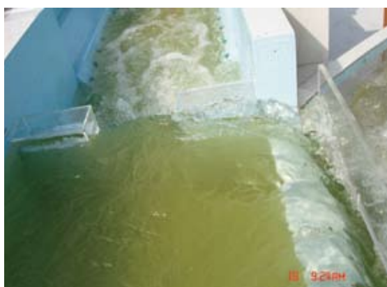
Fig.7 横越流堰の下流端における局所的な水面上昇 The local surface elevation in the downstream edge of the side-weir
