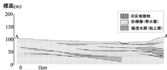
Fig.3 調査地周辺地質断面図(近畿農政局2007) Geological section map of study area
