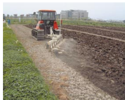
Fig.7 レーザープラウ作業 Work of laser plow
