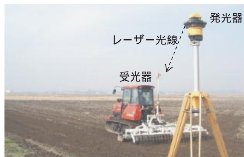
Fig.8 レーザーレベラー（直装式）とゴムクローラ型トラクタ Laser leveler attached on a crawler tractor
