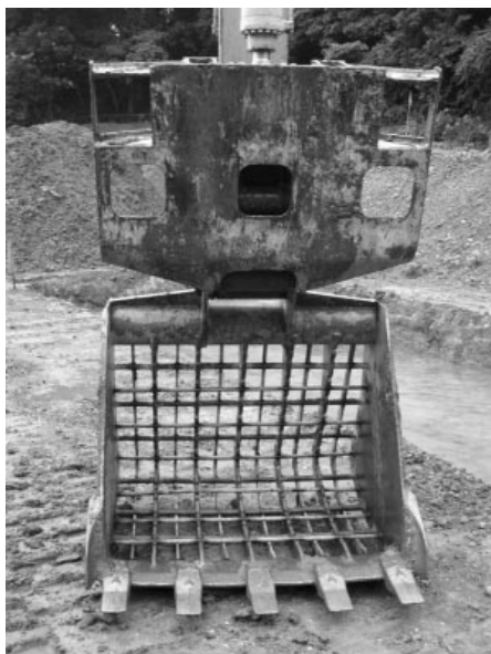
Fig.13 押土板を装着したスケルトンバケット Skelton bucket fitted with pushing plate
