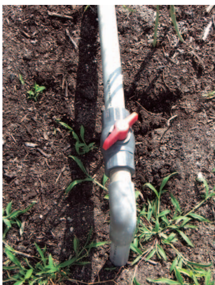
写真5 ボールバルブによる散水量の調節 バルブの開き具合で散水量を調節していた。
