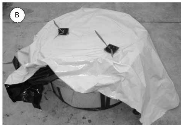
図-8 多孔質フィルムを水槽の資材として利用した水耕装置
