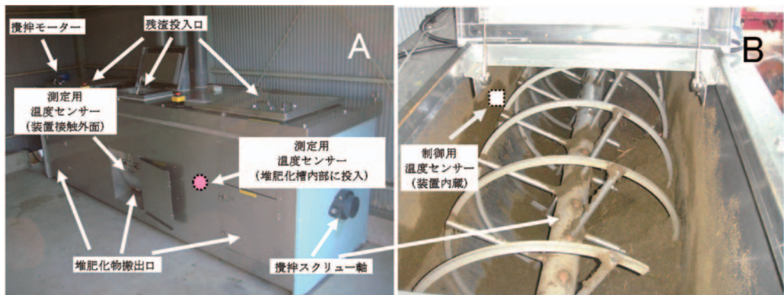
図-1 堆肥化装置の外観と温度測定部分
