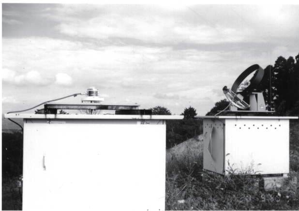
第32図 全天日射量(前)および散乱日射量(奥)の観測装置
