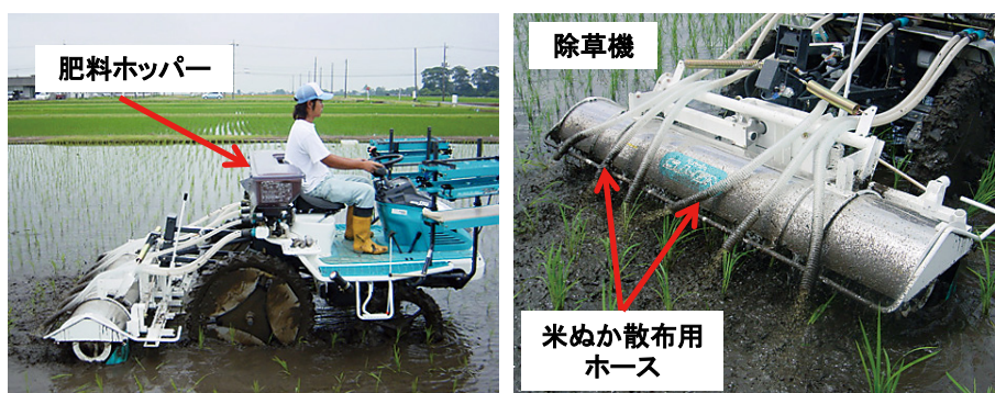
図1 高精度水田用除草機による機械除草同時米ぬか散布作業
