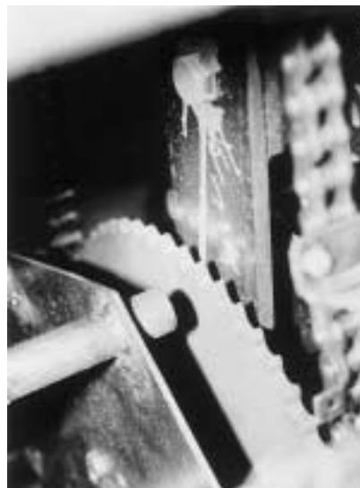
写真 33 均平・取り出しロータ駆動用チェーンホイール
