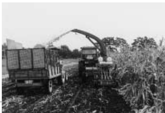
写真4 収穫・施肥・播種同時作業機の作業状況(その2) Photo 4 Harvesting and seeding work by prototype seeder
