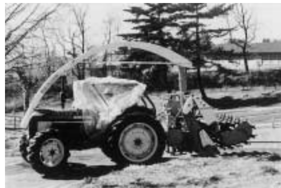
写真9 サイレージアンローダ (トラクタリアマウント型) Photo 9 Silage unloader (Tractor rear mounted type)
