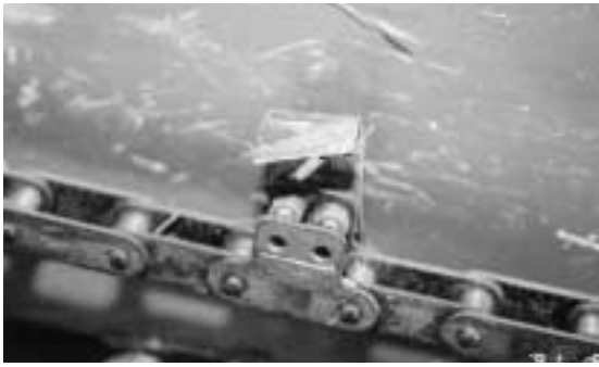
写真 37 チェーンと切断刃 Photo 37 Chain and cutting knife
