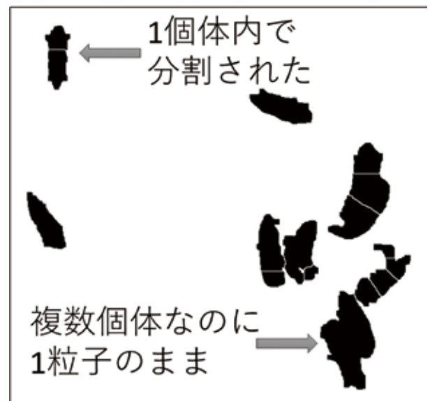
図3 Watershed法による粒子分離の結果 図2cの画像をWatershed法で処理した。
