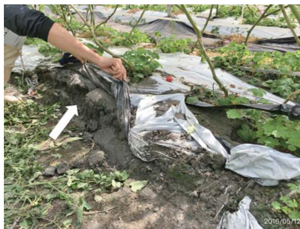
写真1 トマト施設ほ場内のビニールシート下にびっしりと堆積した濃灰色の噴砂（矢印）
