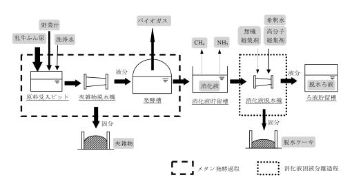
Fig.7 メタン発酵プラントのシステム構成 System constitution of methane fermentation plant
