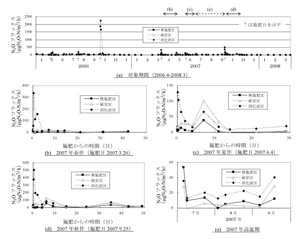
Fig.12 亜酸化窒素フラックス $N_2O$  flux
