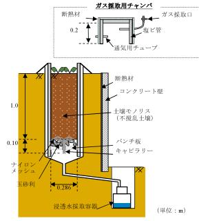
**Fig.8** モノリスライシメータの断面図 Coss-section diagram of monolith lysimeter
