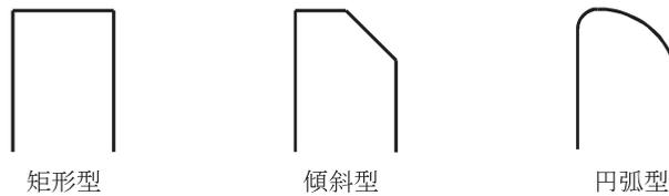
Fig. 2 階段式魚道の隔壁天端の縦断面図(左が上流)
