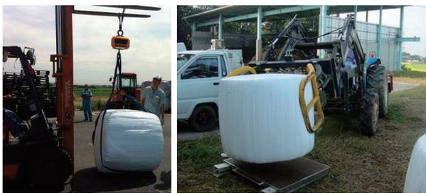
(a) 吊り下げ秤による計量事例
