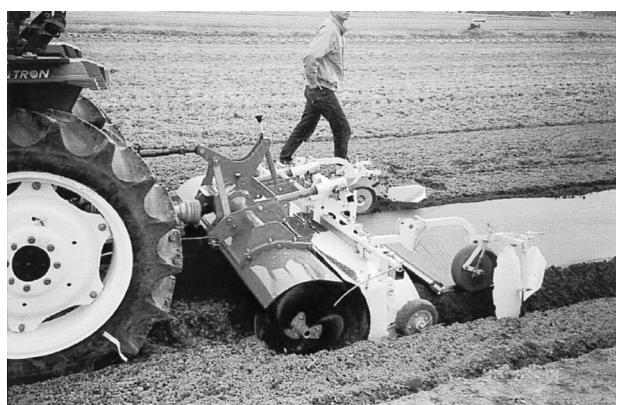
写真2 供試したトラクタ装着式畠立て機
