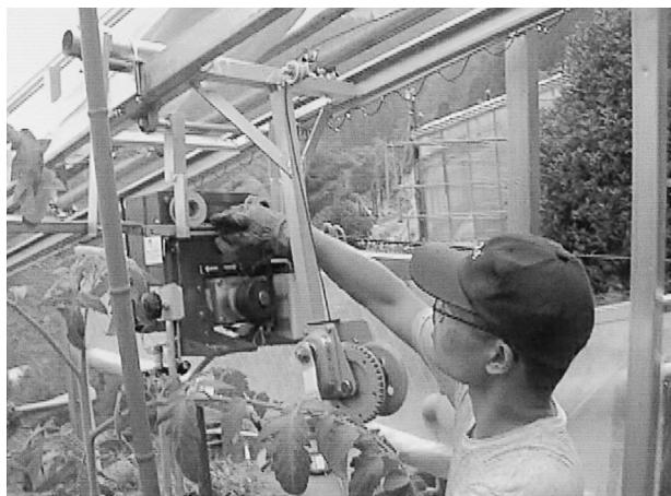
写真16 ウィンチ利用手動台車によるレール間移動
