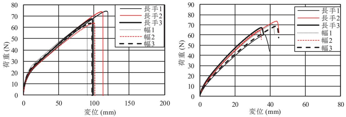
Fig. A6 シートMの荷重変位曲線 (喫水, 左: 引張試験, 右: 引裂試験)
