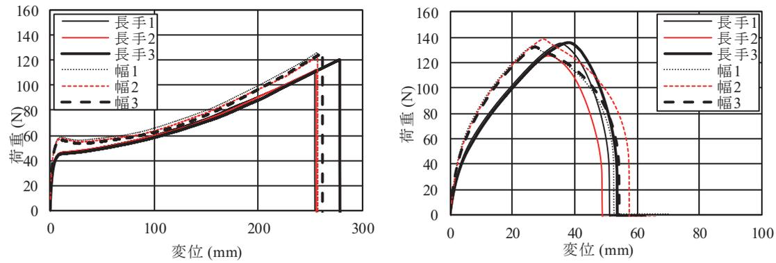
Fig. A2 シートFの荷重変位曲線 (南法面 左: 引張試験, 右: 引裂試験)
