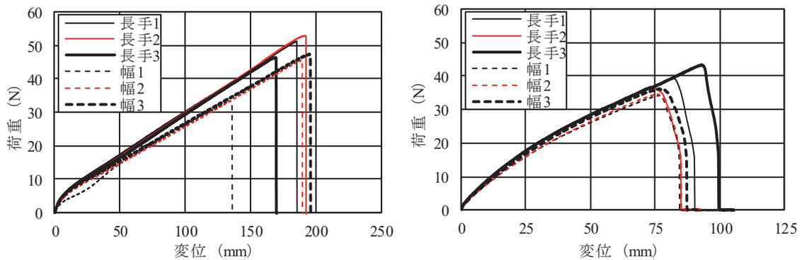
**Fig. A11** シート K の荷重変位曲線 (左：引張試験, 右：引裂試験)
