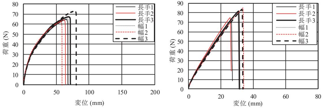
Fig. A5 シートMの荷重変位曲線 (気中, 左: 引張試験, 右: 引裂試験)
