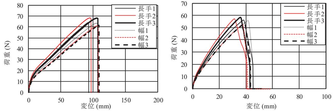
Fig. A9 シート K2 の荷重変位曲線 (喫水, 左: 引張試験, 右: 引裂試験)
