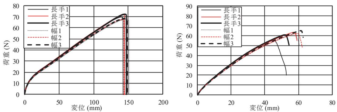
Fig. A7 シートMの荷重変位曲線 (水中, 左: 引張試験, 右: 引裂試験)
