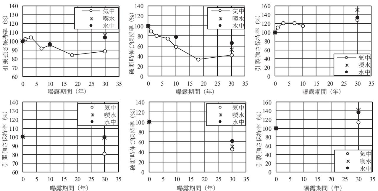
Fig. 8 シート K2 の各種物性の保持率 (上段：長手方向，下段：幅方向)
