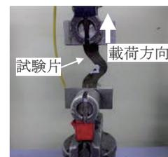
Fig. 5 引裂試験
