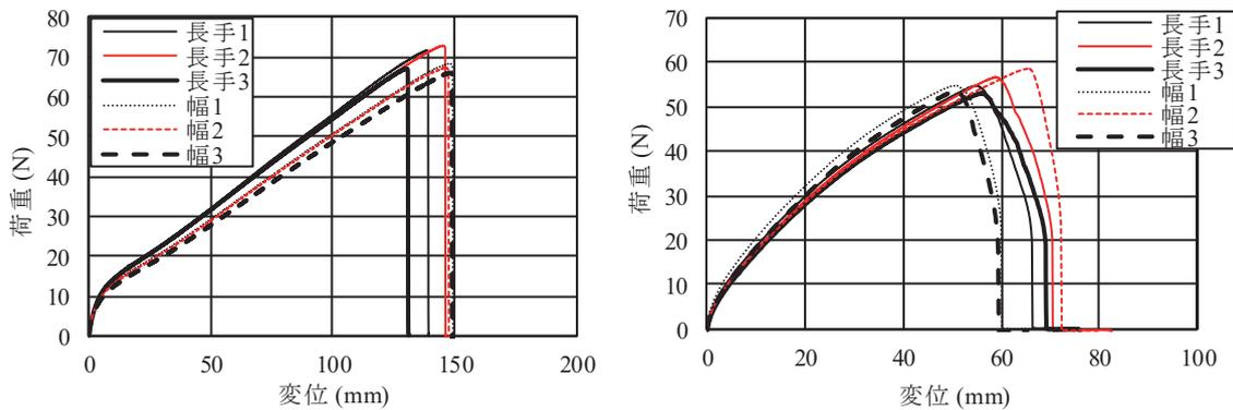
Fig. A10 シート K2 の荷重変位曲線 (水中, 左: 引張試験, 右: 引裂試験)
