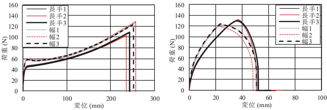
Fig. A3 シートFの荷重変位曲線 (東法面 左: 引張試験, 右: 引裂試験)
