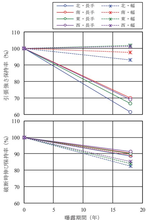
Fig. 6 引張強さおよび破断時伸びの保持率
