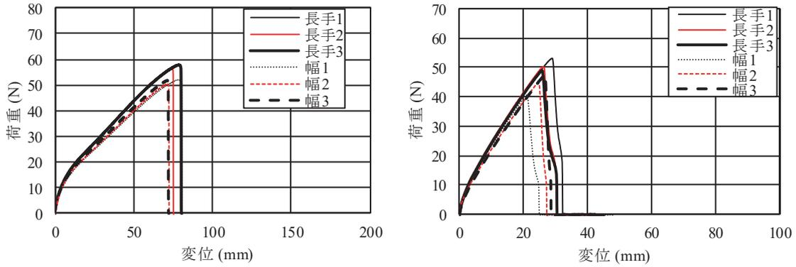
Fig. A8 シート K2 の荷重変位曲線 (気中, 左: 引張試験, 右: 引裂試験)
